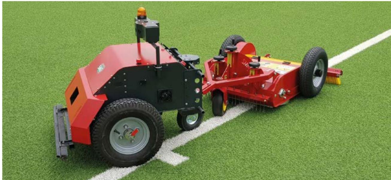
Oben: TurfCare TCA500, Radgetriebenes Anhängegerät für die Reinigung und Pflege von Kunstrasen, Arbeitstiefe der Rotationsbürste und Federzinkenreihe sowie Sieblochung des Rüttelsiebes sind einstellbar; Arbeitsbreite 500mm
