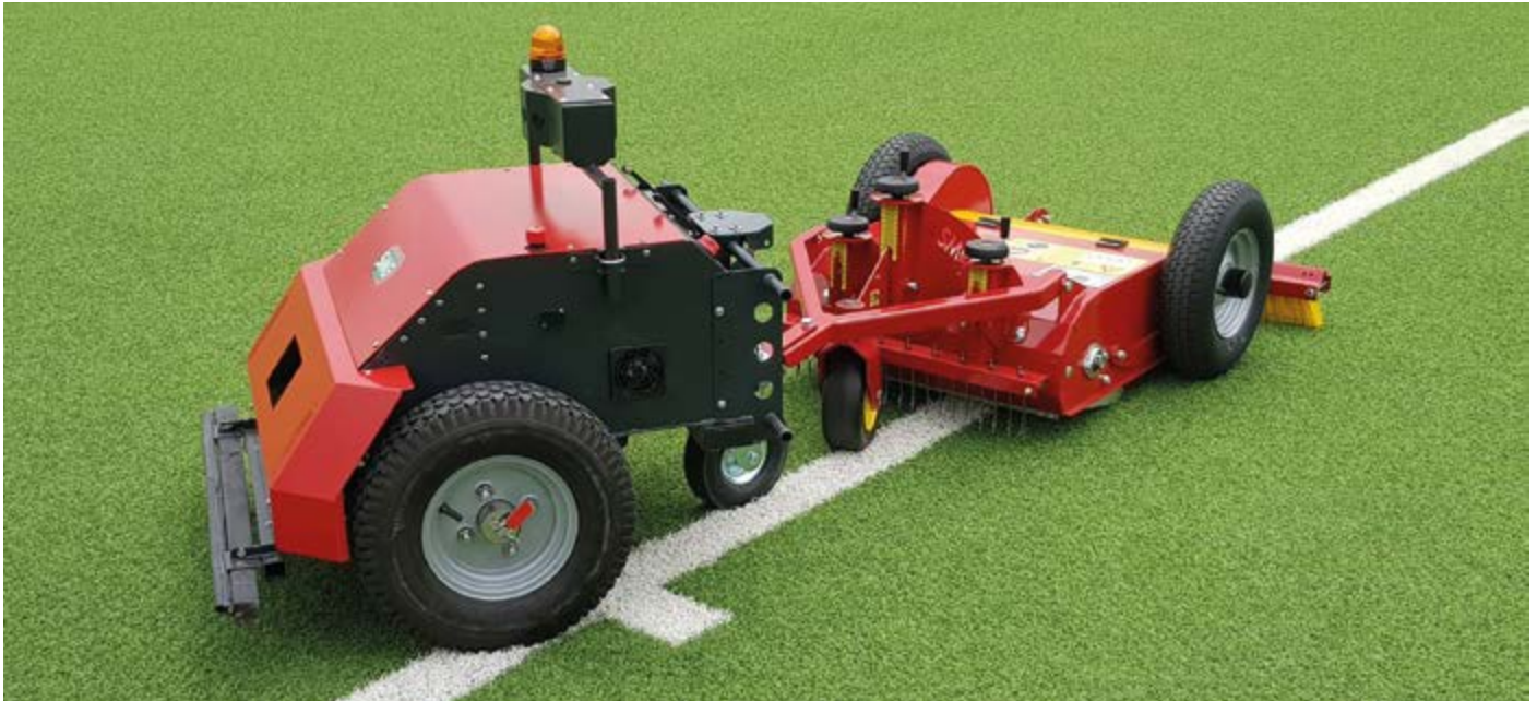
Oben: TurfCare TCA500, Radgetriebenes Anhängegerät für die Reinigung und Pflege von Kunstrasen, Arbeitstiefe der Rotationsbürste und Federzinkenreihe sowie Sieblochung des Rüttelsiebes sind einstellbar; Arbeitsbreite 500mm
